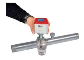
Praxiserprobt: Die Konstruktion des NVS 5200 ermöglicht den Ausbau und die Reinigung der "Messeinheit" ohne den Ausbau der Messstrecke. Eine Verschlusskappe sorgt für die Zeit der Reinigung dafür, dass die Leitung weiter genutzt werden kann. Eine Bypassleitung ist nicht notwendig. Der Passstift sorgt für einen lagegenauen Einbau der Messeinheit.
